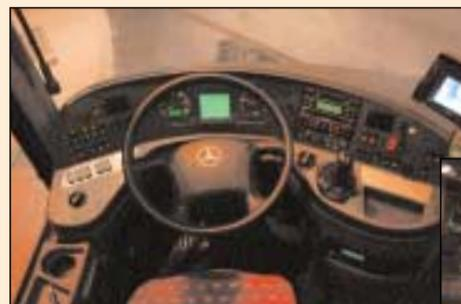
**OPTIMAL** Das Cockpit ist auch nachts gut zu bedienen, alle wichtigen Schalter und Armaturen sind beleuchtet. Der Innenraum überzeugt durch funktionelle Beleuchtung
