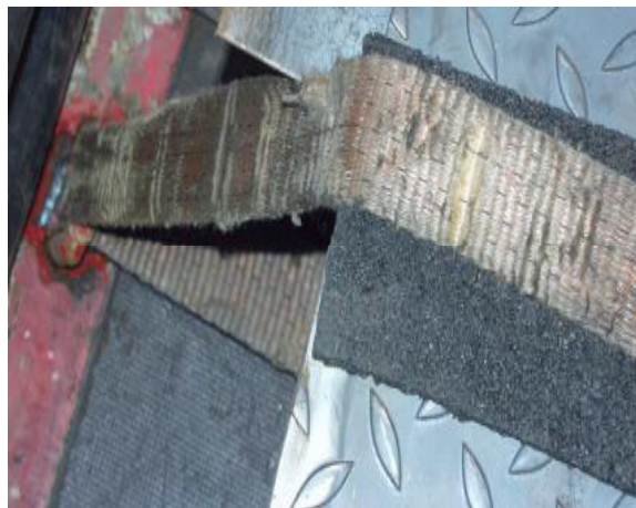
Abb. 31: Ablegereifer Gurt mit Antirutschmatte als Kantenschutz
