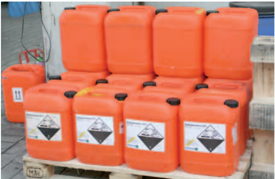
Kanister und IBC werden nach der Packgruppe ausgesucht und sind nicht für alle Packgruppen erlaubt.
