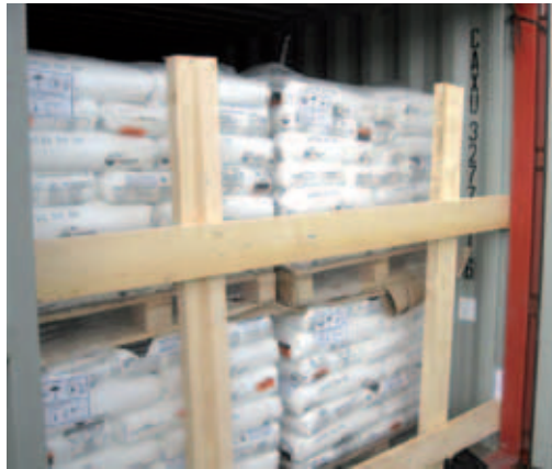
Die Ladung ist durch Blockieren gegen Bewegung zur Containertür gesichert.
