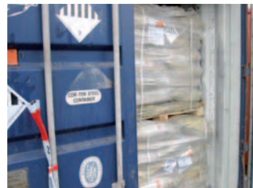
Die Ladung steht formschlüssig an der Containertür.
