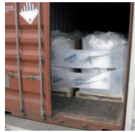
Kommt auch vor: Ladungssicherung mit speziellen Spanngurten (Ty-Gard-System).
