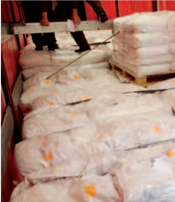
Sichern mit Köpfchen: Sackware lässt sich durch Niederzurren nur mit Hilfsmitteln richtig sichern
