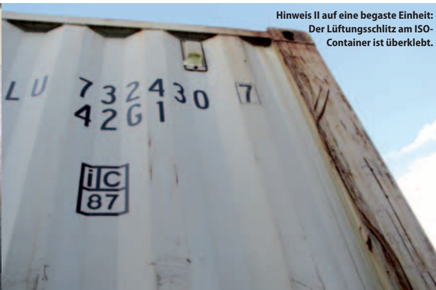
Der überklebte Lüftungsschlitz am ISO-Container ist ein sicheres Zeichen auf eine Begasung.
