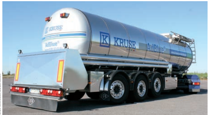
Auf den Transport von AdBlue spezialisiert: Komplett aus Edelstahl gefertigter Dreiachser mit 27.000 Liter Fassungsvermögen von Feldbinder. Lenk- und Liftachse inklusive.
