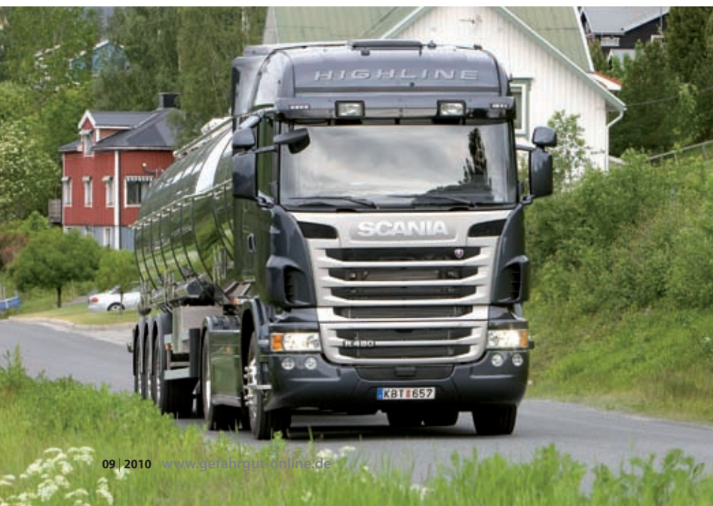
Auf den Transport von AdBlue spezialisiert: Komplett aus Edelstahl gefertigter Dreiachser mit 27.000 Liter Fassungsvermögen von Feldbinder. Lenk- und Liftachse inklusive.
