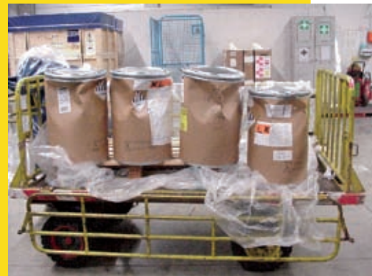
Beschädigung durch Druckschwankung bei Ausladung aus Flugzeug festgestellt, Papptrommeln nur halb gefüllt.
