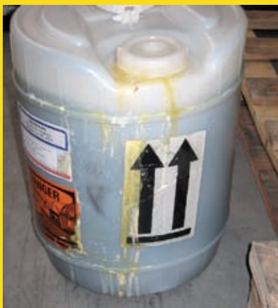
Kontamination an der Außenverpackung, vermutlich beim Befüllen.
