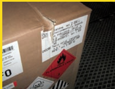
Beschädigte Gefahrgutsendung: Verzurr Schaden.
