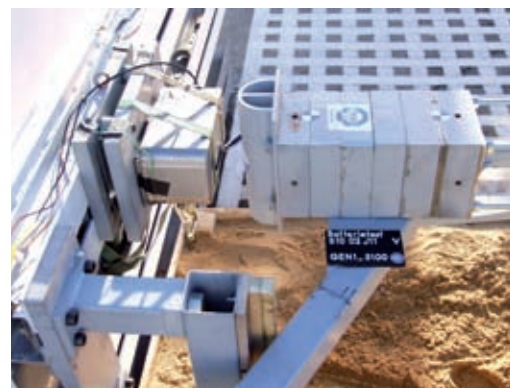
Typische Crashesituation: Mit knapp 30 km/h trifft der Stoßkörper auf die Batterie.
