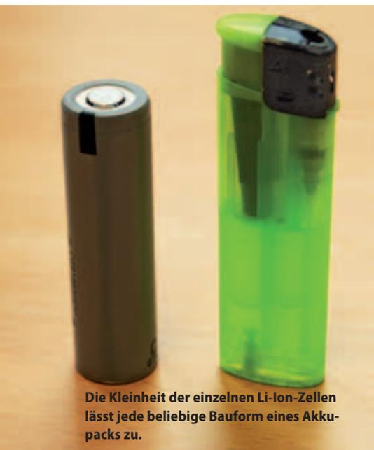
Die Kleinheit der einzelnen Li-Ion-Zellen lässt jede beliebige Bauform eines Akkupacks zu.
