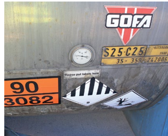
Der Befüller sorgt nach der Beladung für die entsprechenden Placards am Tank.
