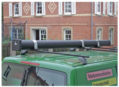
Kein Abknicken oder Beschädigen mehr – mit den Transportrohren von ROWEKO lassen sich Langgüter auf dem Fahrzeugdach sicher transportieren
