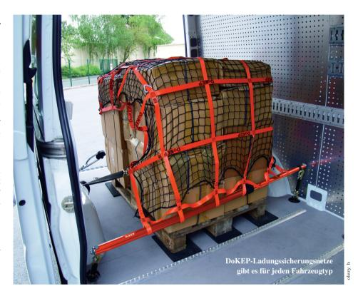
typ gem ht. ur korrekten dungssi herung muss d s so usgewählte etz nur no h ü er die dung gelegt und mit den zum etz d zugehörenden hnellsp nnern verzurrt werden. mit ist d s dungsgewi ht is zur m xim len ul dung des hrzeugs korrekt gesi hert.
