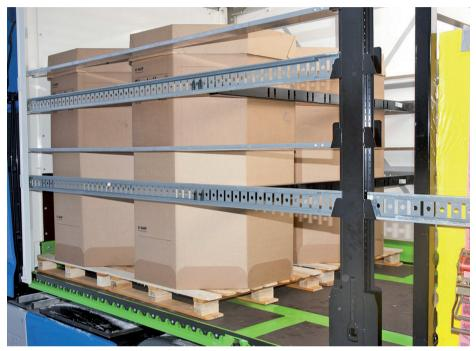
Für jede Ladung eine Lösung. Auch Oktabins lassen sich mit dem KRONE Multi Safe System sicher transportieren
