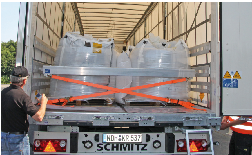
Regelmäßige diagonalverzurrte Querbalken und Staupolster halten die Big Bags im Formschluss.
