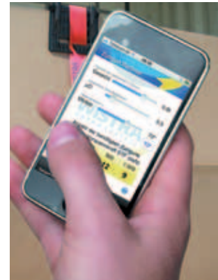
Die Zurrurt-App von Wistra kann für das Niederzurren wie für das Diagonalzurren genutzt werden.
