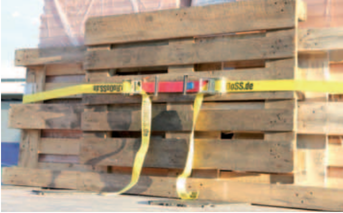
Mit dem Doppelspanner RoDoSS von G&H Rothschenk kann der Fahrer auf der Ladefläche sichern, ohne mehrmals auf- und absteigen zu müssen.
