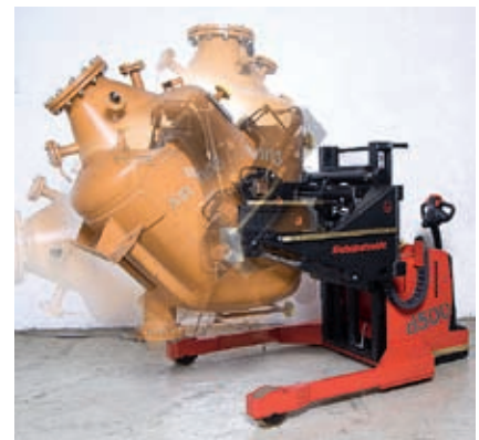
Der Deichselstapler von Sichelschmidt kann Behälter auch horizontal drehen.
