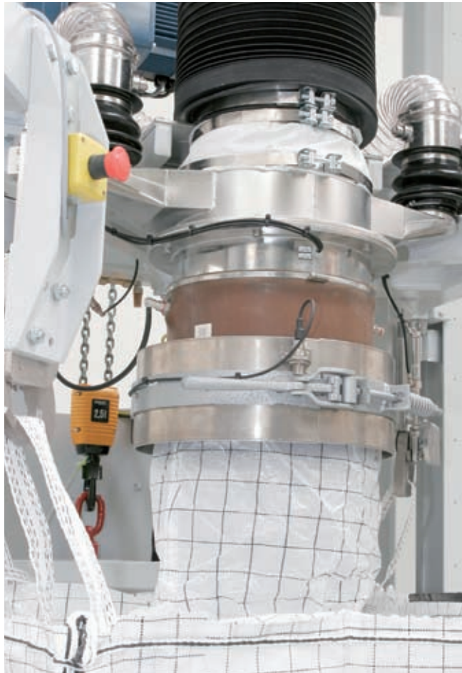
Die integrierte Blähmanschette sorgt für eine staubfreie Befüllung der FIBC.
