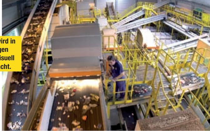
Die Wertstoffsartierung wird in modernen Recyclinganlagen computergesteuert und visuell durch Mitarbeiter überwacht.
