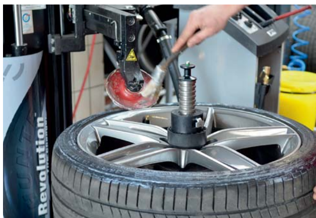
Sorgfältiges Fetten ist das A und O bei der Reifenmontage
