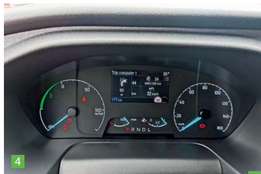
■ 1 Die Antriebsräder sind via Heavy-Duty-Aufhängung mit dem Leiterraum verbunden ■ 2 Der Ladeanschluss ist clever platziert ■ 3 Mit dem Rad in der Mitte wird der Modus gewählt ■ 4 Power-Meter statt Drehzahlmesser
